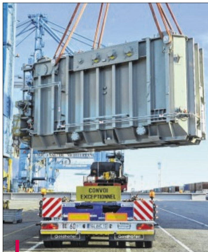
Le déchargement du transformateur électrique lors de son arrivée à Fos-sur-Mer en décembre.
