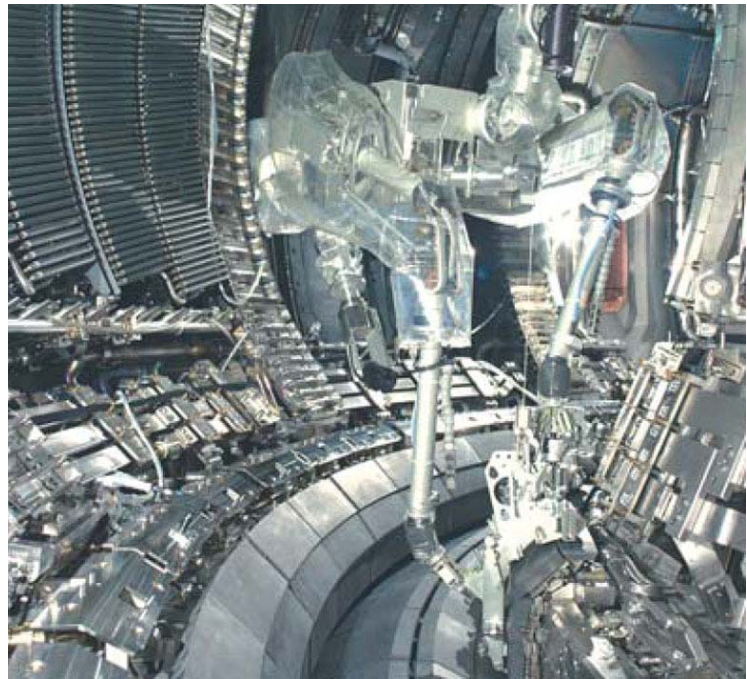
Figure 3 : Téléopération à l'intérieur de la chambre à vide
