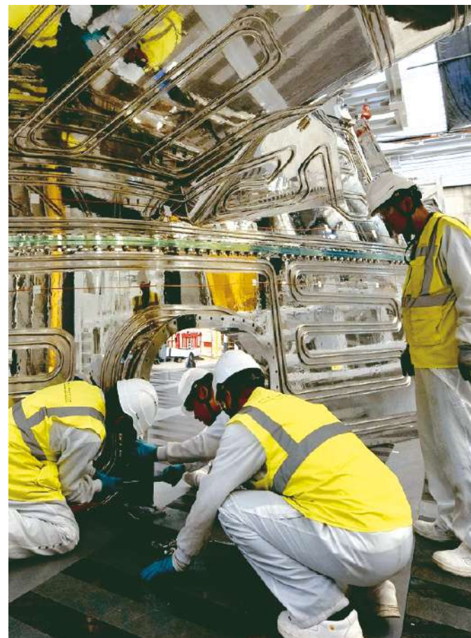
▲ La couche d'argent qui existait sur ce panneau d'écran thermique à l'origine a été enlevée et sa surface a été hautement polie.
