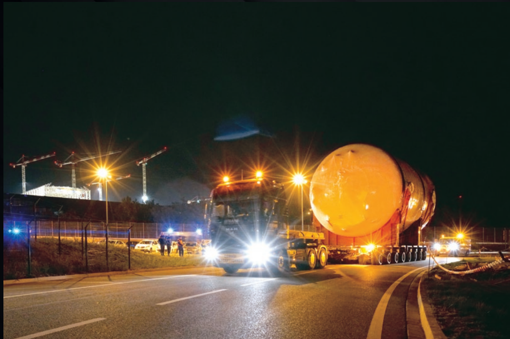
Fourni par les États-Unis, un des cinq réservoirs de drainage destinés au système de refroidissement du tokamak vient d'être livré sur site.
