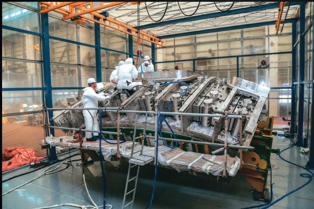
En Corée, Hyundai Heavy Industries doit fabriquer 4 des 9 secteurs de la chambre à vide du tokamak. Sur cette photo, des techniciens insèrent des blocs de protection neutronique dans un segment du secteur n° 6, qui sera finalisé en 2019.
