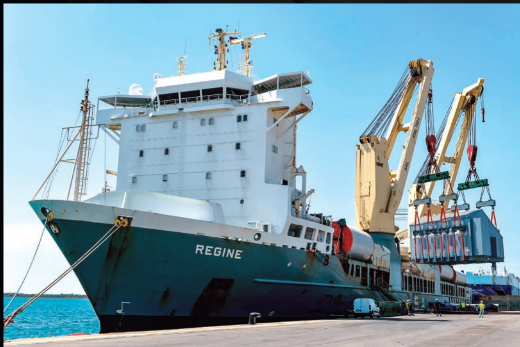
Fourni par la Corée, un premier secteur de chambre à vide, une pièce particulièrement massive (440 tonnes), est en cours de déchargement au port de Fos-sur-Mer.
