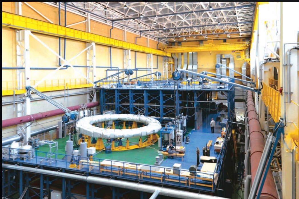
La plus petite des bobines de champ poloidal (9 mètres de diamètre) est en cours de fabrication au chantier naval Srednevesky de Saint-Petersbourg, en Russie. La première de ses huit « doubles galettes » est terminée.
