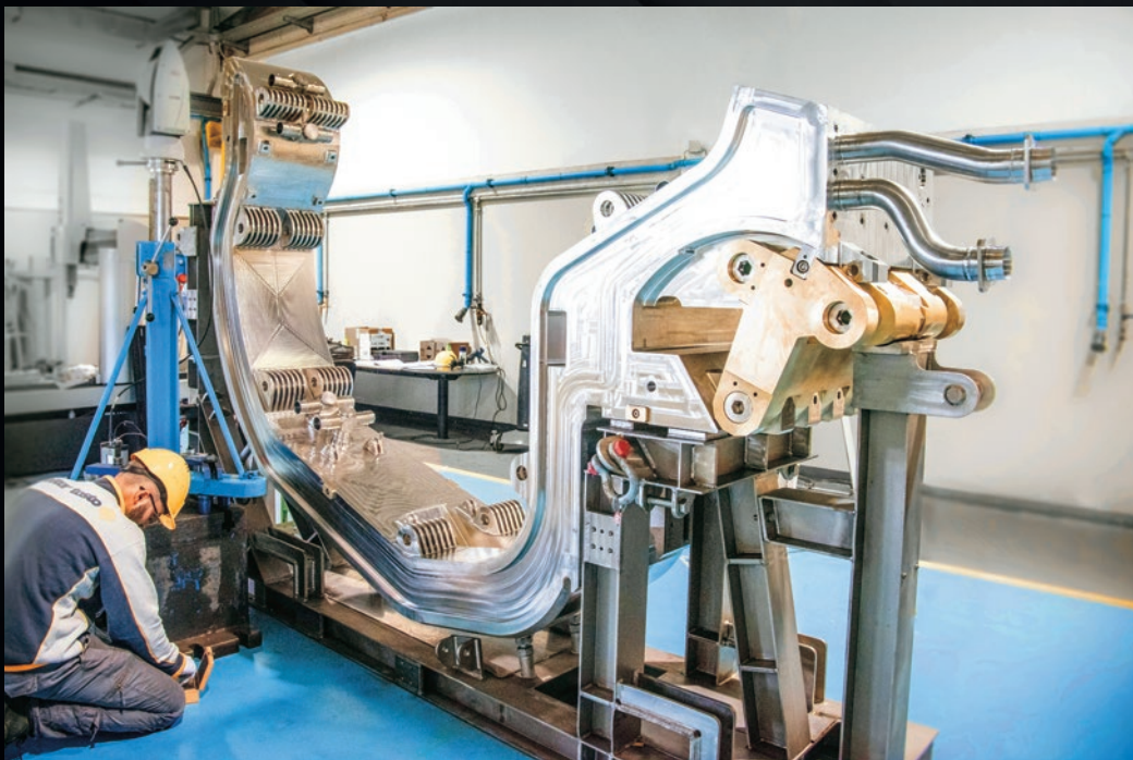
Les éléments directement exposés au plasma, les systèmes de diagnostics et de refroidissement du divertor seront assemblés sur ces châssis de 8 tonnes ( divertor cassettes ) dont un prototype à échelle 1:1 vient d'être réalisé par l'entreprise italienne Walter Tosto.
