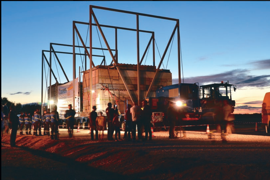
Une centaine de kilomètres séparent le site d'ITER du port de Marseille-Fos où sont déchargées les plus volumineuses des pièces de la machine. L'itinéraire dédié, que la France a aménagé, a été testé avec une charge de 600 tonnes.
