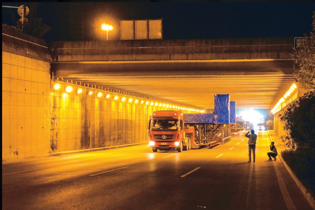
Cet élément semi-circulaire fait partie du système d'alimentation électrique et cryogénique des bobines de correction. Ce convoi est en route vers le port de Shanghai et, de là, vers le site d'ITER.
