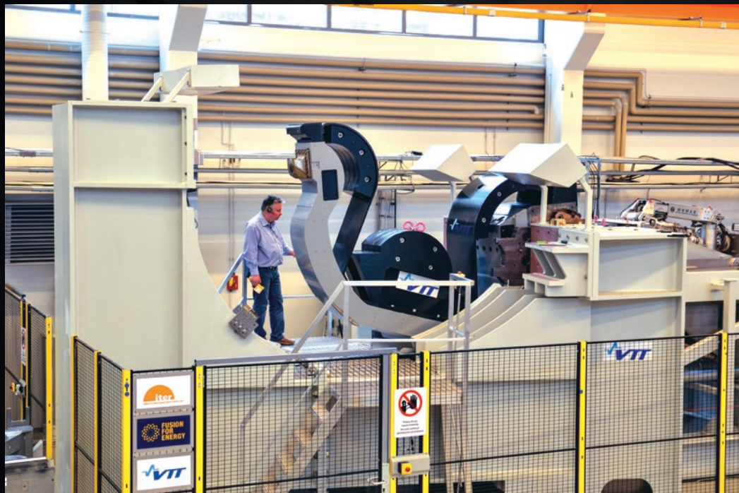
L'Europe fournit le système de télémanipulation du divertor de la machine. Ici, début 2015 au DTP2 Divertor Test Platform facility de Tampere, en Finlande, on procède aux tests finaux sur l'une des 54 cassettes du divertor
