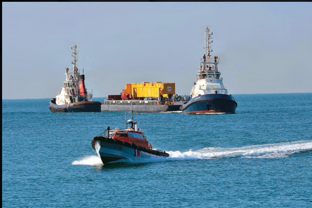
Tirée et poussée par deux puissants remorqueurs, et escortée par un détachement de la Gendarmerie maritime, la barge de transport et son chargement (un semi-remorque et une poutre de pont roulant de 155 tonnes) s'apprêtent à entrer dans l'étroit chenal qui donne accès à l'Étang de Berre.
