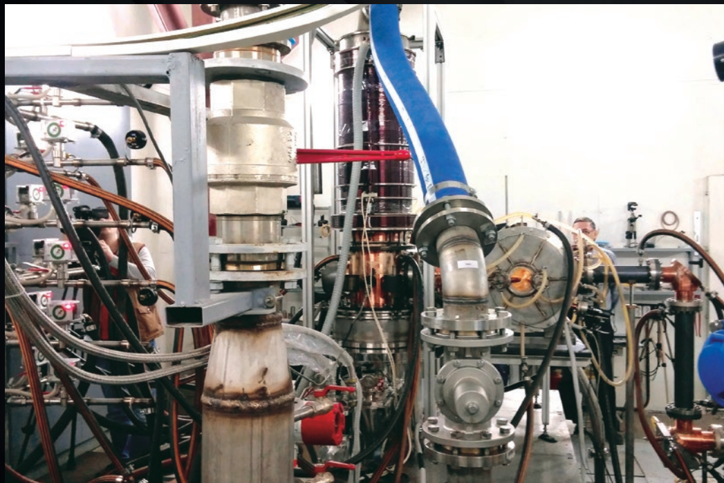
Au mois de mai 2015, un prototype de « gyrotron », le dispositif qui génère les puissants faisceaux de micro-ondes utilisés pour chauffer le plasma, vient de subir avec succès les tests de réception dans les ateliers de la société Gycom Ltd. à Nijni Novgorod, en Russie.
