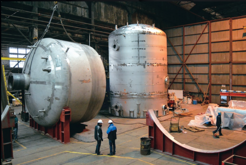
Des cuves de drainage destinées au circuit de refroidissement du tokamak sont en cours de fabrication dans l'usine Joseph Oat Corporation de Camden, dans le New Jersey.
