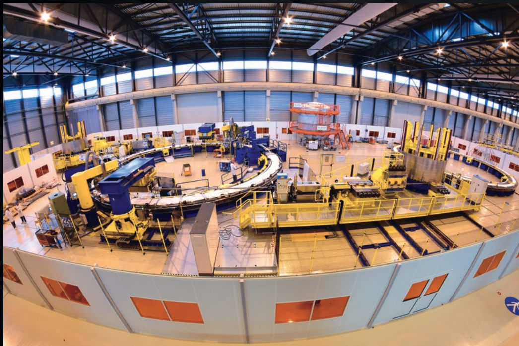
Quatre des six bobines de champ poloidal qui ceignent le tokamak seront fabriquées sur site par l'Europe, dans cette usine dont l'outillage est en cours de qualification.
