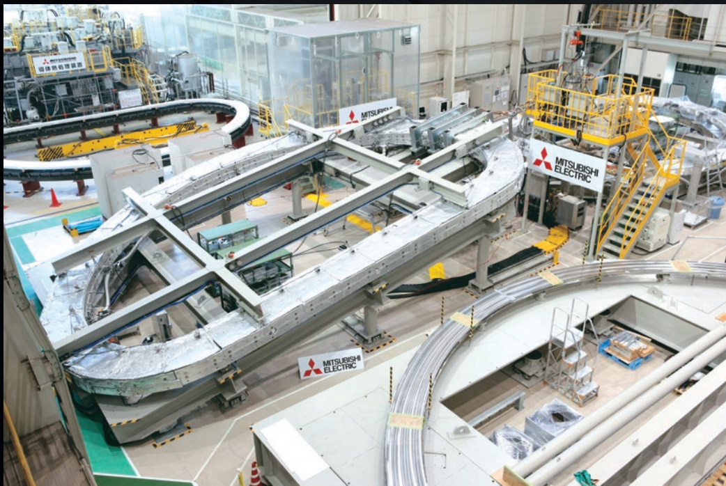
Chez Mitsubishi Heavy Industries, à Futami, au Japon, la production en série des « doubles galettes » qui forment le cœur des bobinages des aimants de champ toroidal du tokamak est lancée.
