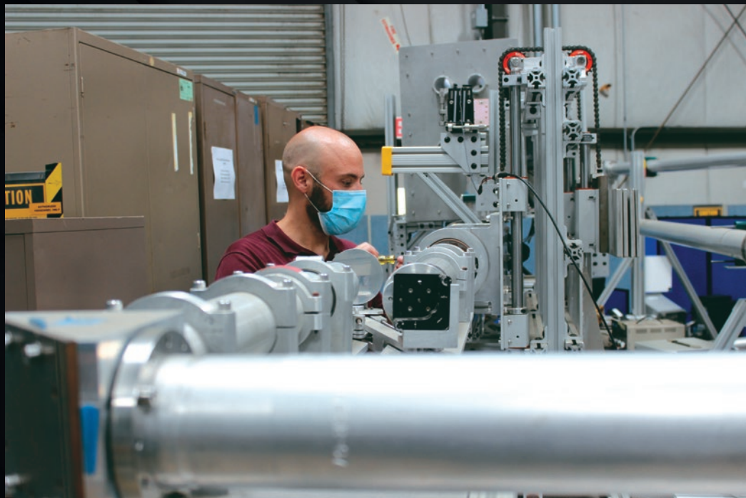
En Californie, General Atomics développe le prototype d'un système de diagnostics par réflectométrie, qui permet de mesurer les fluctuations de la densité d'électrons dans le plasma.
