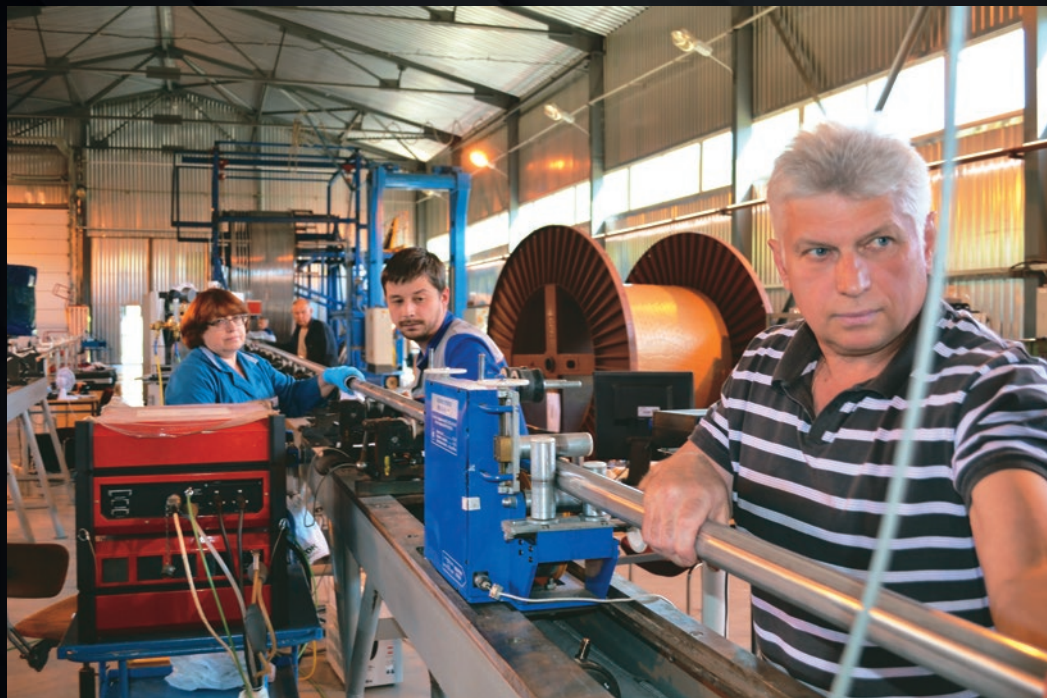
Au mois de juin 2015, à l'Institut de physique des hautes énergies de Protvino, près de Moscou, les spécialistes du Cable Institute (JSC VNIIPK) finalisent la production de câbles supraconducteurs destinés aux aimants de champ toroïdal du tokamak. Au total, en cinq ans, 120 tonnes de « câbles en conduit » auront été produites par la Russie.
