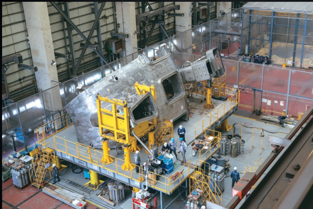
Hyundai Heavy Industries a consacré près de dix années à l'élaboration de cette pièce – un des 4 secteurs (sur 9) de la chambre vide du tokamak, dont la fabrication incombe à la Corée.
