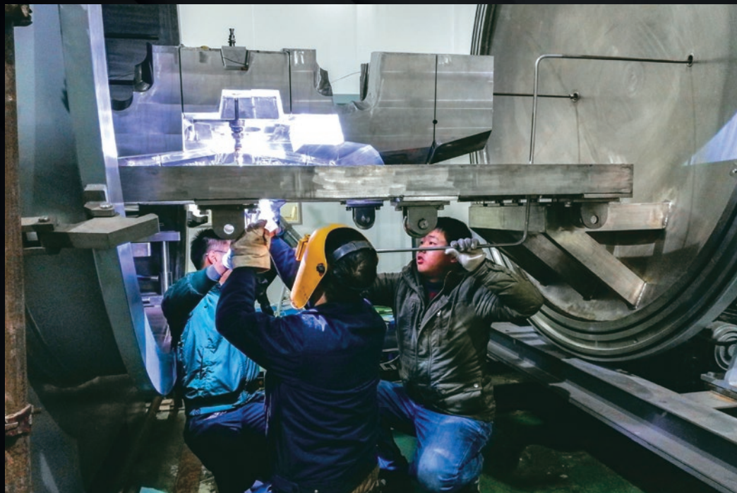
Bon pour le service : les tests d'étanchéité auxquels ce bloc de protection ( shield block ) d'un poids de 2,8 tonnes vient d'être soumis en Chine confirment son adaptation à l'ultravide qui régnera au cœur du tokamak.
