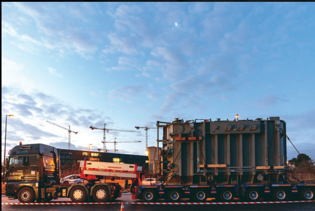
Un transformateur électrique de 90 tonnes, fourni par les États-Unis, inaugure « l'itinéraire ITER ». Quelque 250 convois « hautement exceptionnels » vont se succéder tout au long des phases de construction et d'assemblage de l'installation ITER.
