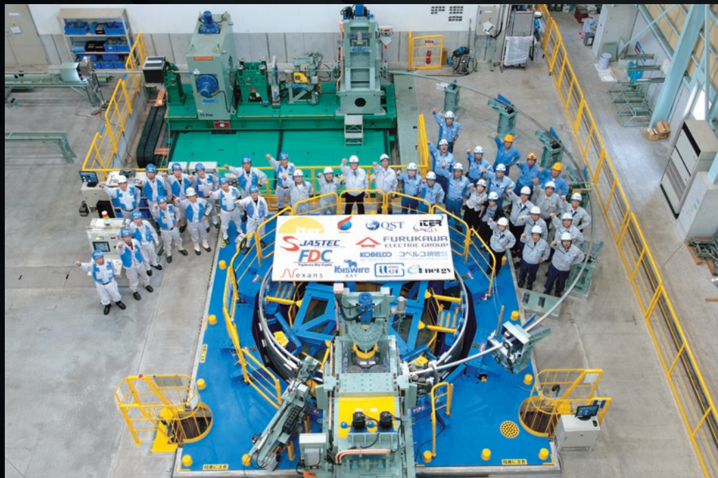
À l'usine Wakamatsu de Nippon Steel and Sumikin Engineering Co. Ltd., au Japon, la fabrication de 43 kilomètres (700 tonnes) de câbles supraconducteurs en niobium-étain destinés au solénoïde central du tokamak vient d'être finalisée.
