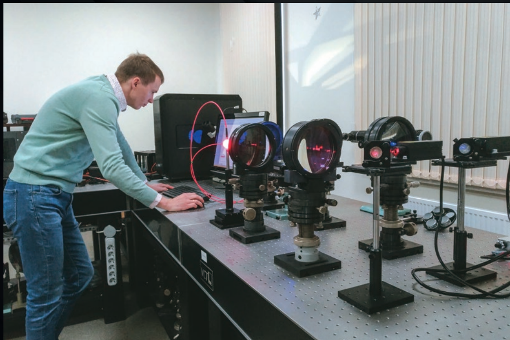
Un laboratoire de spectroscopie a été créé à Moscou pour accompagner le développement des systèmes de diagnostics optique qui mesurent les profils de température et de densité du plasma.
