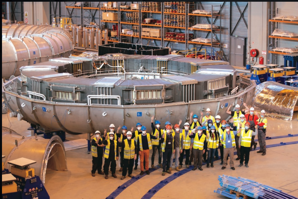
Fournie par l'Europe mais fabriquée en Chine, la bobine de champ poloidal n° 6 (PF6) vient de subir pendant trois mois des tests sous vide à très basse température. PF6 sera la première bobine à prendre place dans le puits d'assemblage.
