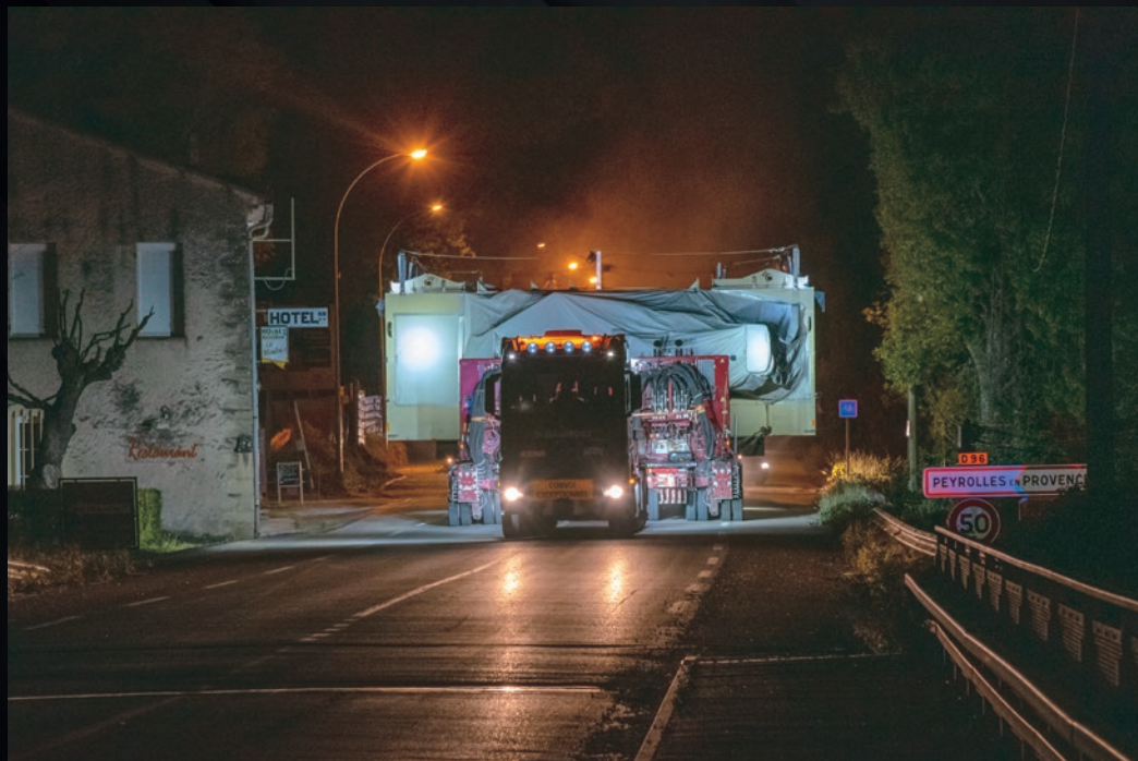
La puissante remorque qui transporte cette bobine de champ toroïdal en provenance du Japon est un prototype développé par la société hollandaise Mammoet pour le compte du prestataire logistique DAHER. Développant deux fois 1 000 CV, on la voit ici traverser de nuit le village de Peyrolles-en-Provence lors de la dernière étape de son long voyage.
