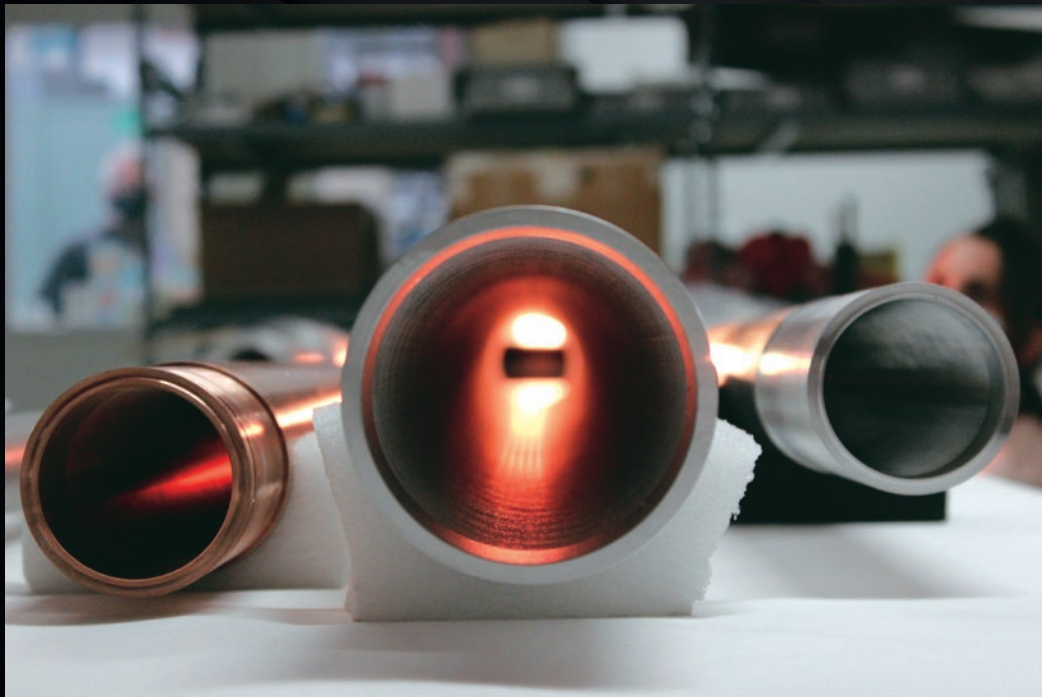
La fabrication des premiers éléments des lignes de transmission du chauffage électron-cyclotron est en cours aux États-Unis. Ici, des prototypes de guides d'ondes
