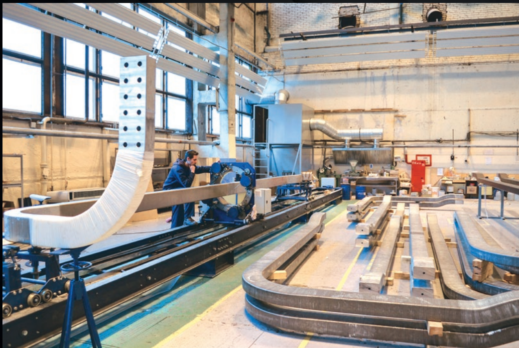
Ces « jeux de barres » activement refroidis transportent le courant continu destiné aux aimants supraconducteurs. Près de 5,5 kilomètres (500 tonnes) de ces éléments de très haute technologie sont en cours de fabrication à l'Institut Efremov de Saint-Pétersbourg, en Russie.
