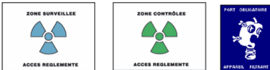
Figure 4 : Exemples de panneaux de signalisation radiologique
