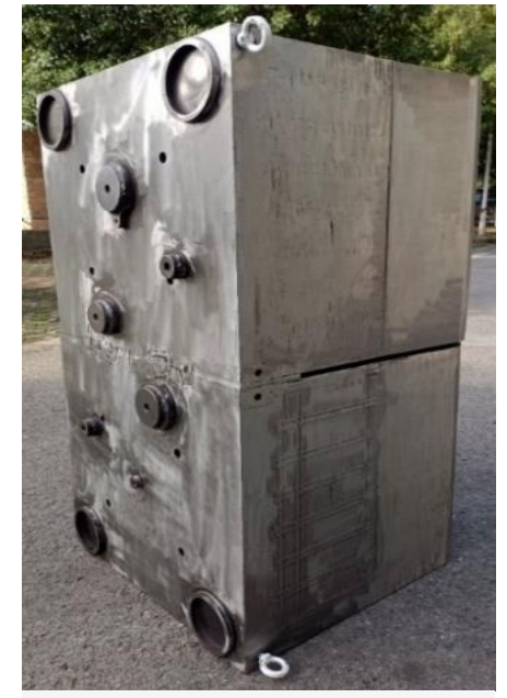
Semi-Prototype HCCB TBM Module
