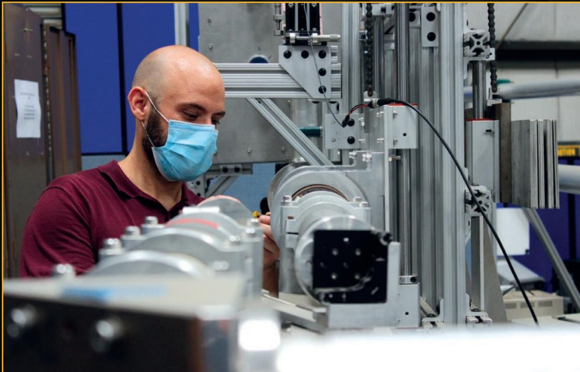
En Californie, General Atomics développe le prototype d'un système de diagnostics par réflectométrie, qui permet de mesurer les fluctuations de la densité d'électrons dans le plasma.
