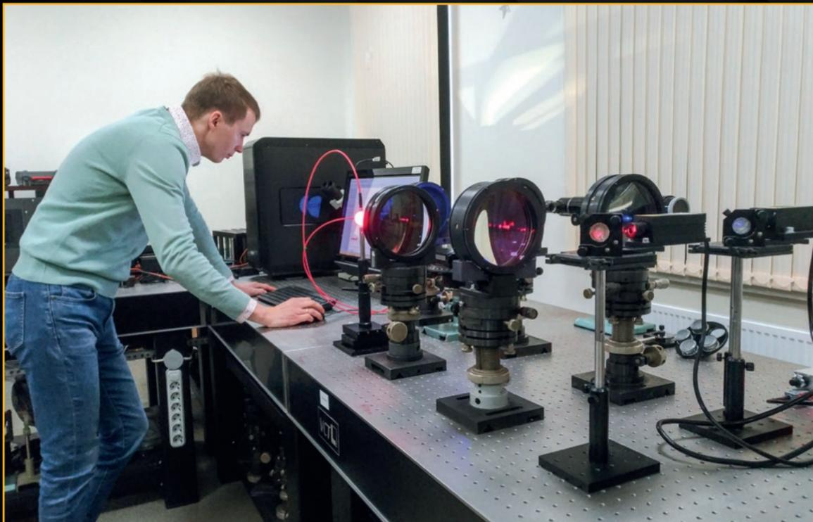
À Moscou, dans un laboratoire de spectroscopie, les spécialistes de l'Agence domestique russe développent des systèmes de diagnostics optiques pour le Tokamak ITER.
