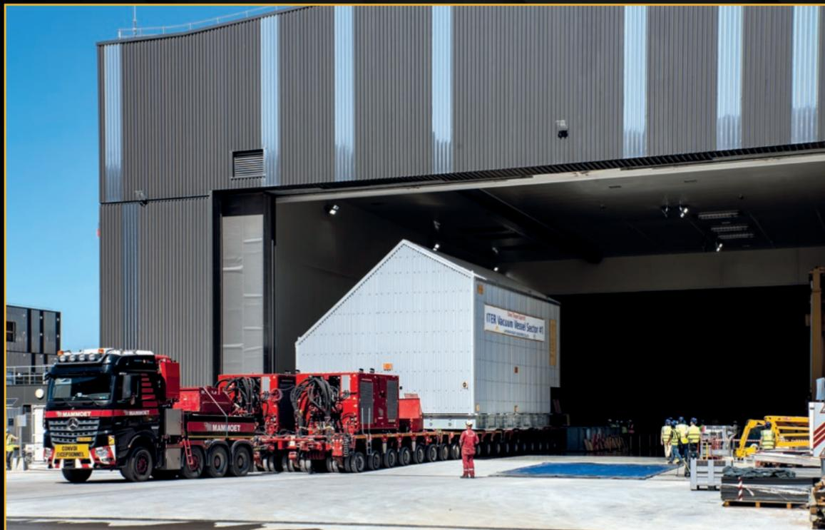
Un deuxième secteur de chambre à vide vient d'être livré par la Corée. Les neuf secteurs de 40° qui, une fois assemblés et soudés, forment l'espace toroïdal au cœur de la machine, sont tous quasiment identiques. Seuls quelques détails, liés à leur position respective et aux éléments avec lesquels ils sont connectés, les différencient les uns des autres. **Août 2021**
