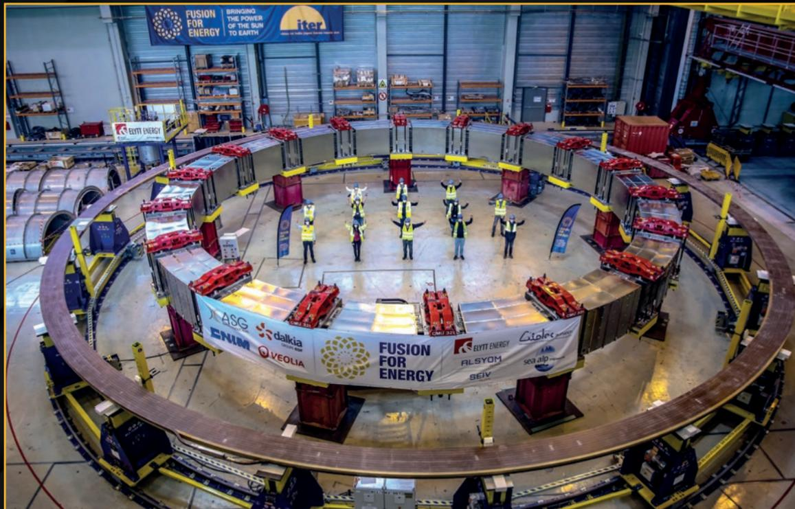
La fabrication de PF5 (17 mètres de diamètre), la première des bobines annulaires produites sur site par l'Europe, vient de se terminer et tous les tests ont été passés avec succès. Une seconde bobine, PF2, de même dimension, sera finalisée au mois de décembre. **Avril 2021**
