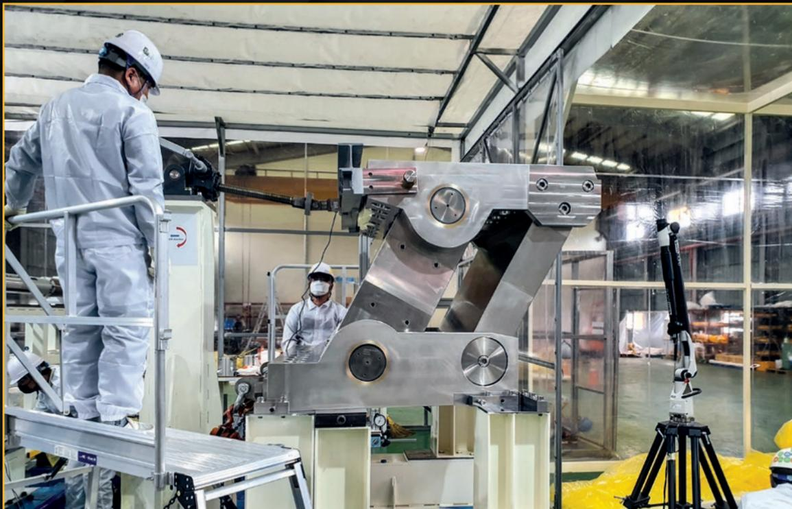
Au nombre de 9, ces structures d'acier (*gravity supports*) placées sous la chambre à vide compensent les phénomènes d'expansion thermique et supportent des charges importantes dans les directions radiale, toroïdale et verticale.
