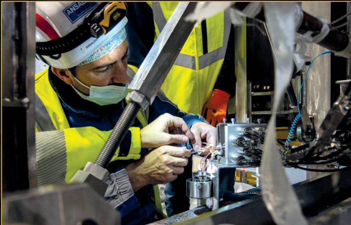
Dans une installation expérimentale comme ITER, les systèmes de diagnostics sont essentiels. Ici, une bobine de champ toroidal (verticale) est équipée de capteurs avant d'être transférée dans un des portiques de pré-assemblage. **Mars 2021**
