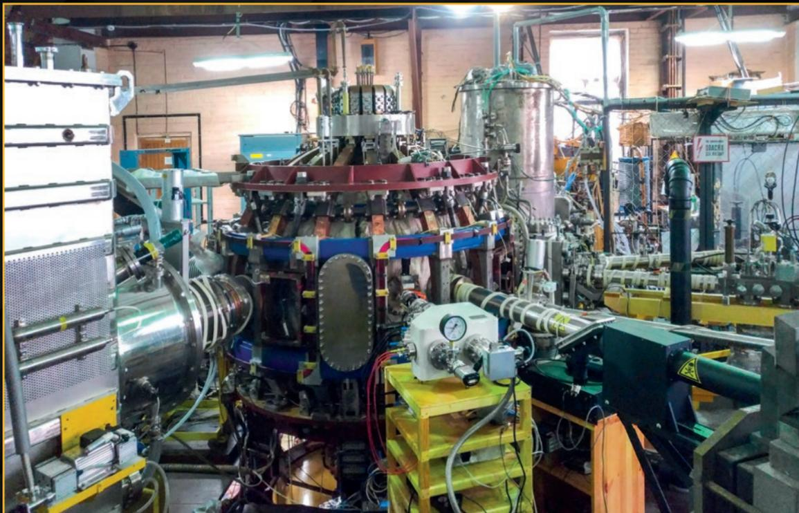
À l'Institut Ioffe de Saint-Petersbourg, le tokamak sphérique Globus-M2 est utilisé pour tester et calibrer les sources laser et les spectromètres d'un des systèmes de diagnostics (diffusion Thomson) du divertor d'ITER.
