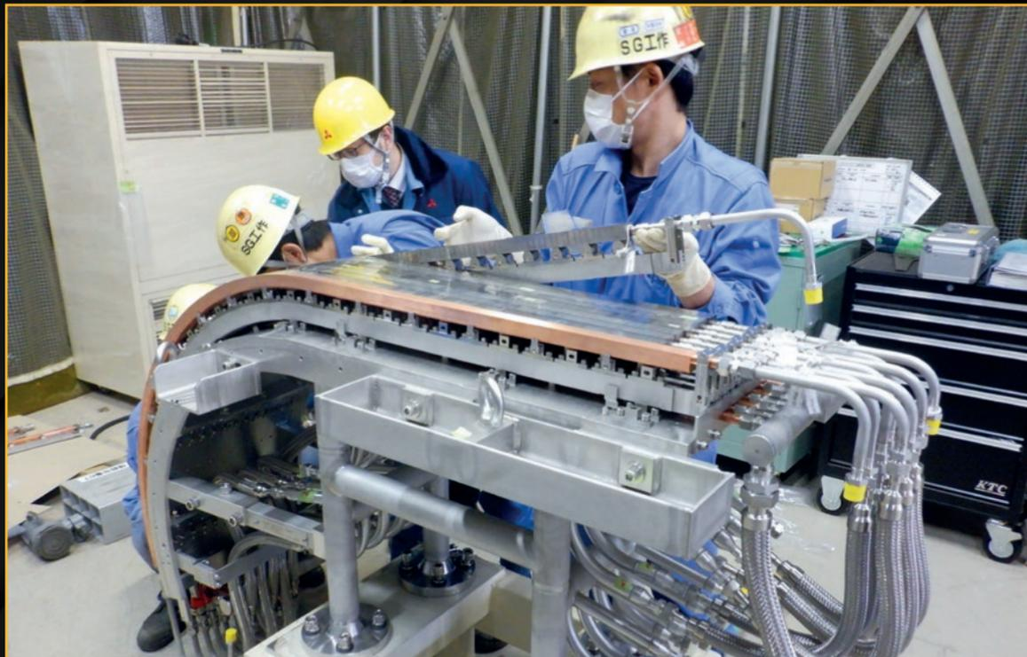
Un des éléments du divertor directement exposé au plasma est placé sur un banc-test pour être exposé aux conditions thermiques extrêmes qui régneront dans la partie basse de la machine.
