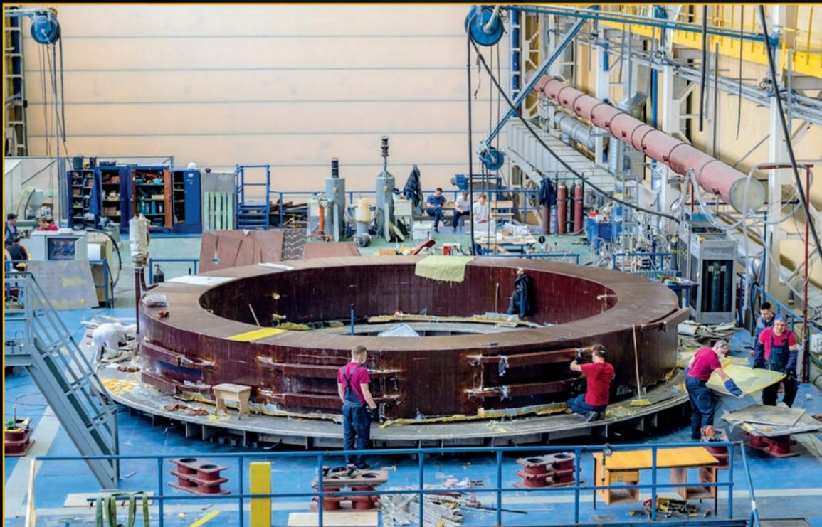
Au début de l'année 2021, la phase d'imprégnation de résine de la bobine de champ poloidal n°1 (PF1) est terminée. Cette opération confère à la bobine isolation électrique et rigidité structurelle. Au mois de mars suivant, PF1 a passé avec succès tous les tests requis.
